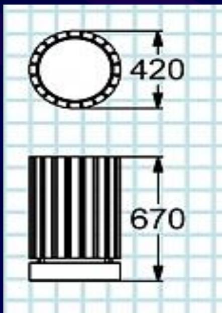
Деревянная цилиндрическая урна с металлической оцинкованной вставкой с двумя ручками выполнена на металлическом каркасе из полосы шириной 40 мм, установленном на железобетонном основании толщиной 100 мм. На каркасе установлены деревянные доски сечением 50х30 мм.
