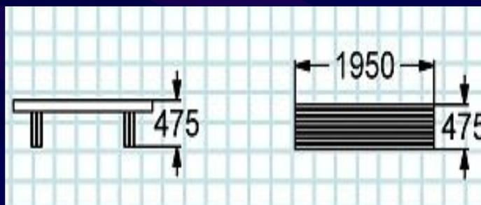
Скамья садово-парковая выполнена на железобетонных ножках. Сидение состоит из деревянных досок сечением 65x40 мм и 110x40 мм. Деревянные детали должны быть тщательно отшлифованы, грунтованы и окрашены профессиональными акриловыми красками в заводских условиях.
