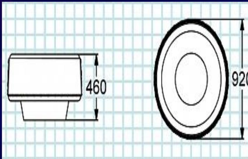
Монолитная круглая железобетонная
