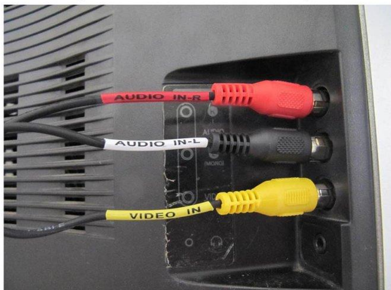
Рисунок 6 – Подключение по буквенному обозначению разъемов: а – цвета разъемов кабеля отличаются от цветов разъемов телевизионного приемника (есть буквенное обозначение); б – буквенное обозначение разъемов на телевизионном приемнике; в – присоединение кабеля к телевизионному приемнику
